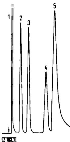
Abb. 1. Gaschromatogramm. 1: Äthylenoxid, 2: 2-Chloräthan, 3: 2-Bromäthan, 4: 2-Jodäthan, 5: Äthylenglykol.
